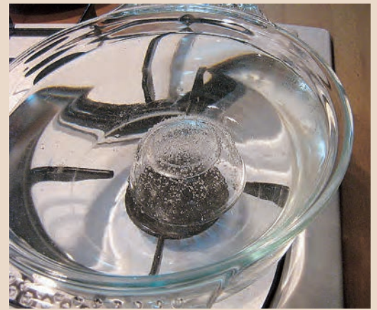
Figure 6 : l'eau n'est pas encore à 100°C, mais elle a libéré pratiquement tous les gaz ; ceux qui ont été libérés sous la coupelle renversée y ont formé une bulle qui les met bien en évidence. Le volume important de la bulle est essentiellement dû au fait que, à cette température relativement élevée, les gaz sont dilatés. Cliché de l'auteur.
