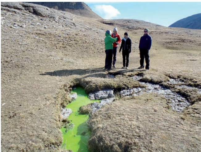
Figure 1 : coloration de la perte du lac de Lignin (alt. 2300 m, Colmars-les-Alpes, Alpes de Haute-Provence), un extrême amont du système fluvio-karstique Coulomp-Chamois. Cliché de l'auteur.
