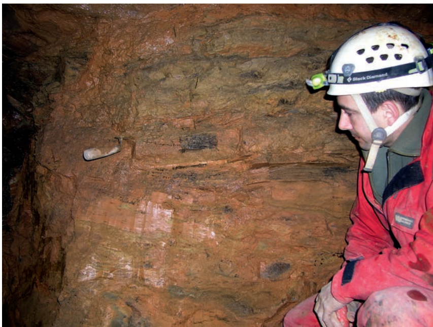
Figure 15 : fantôme de roche dans l'ancienne mine de la Grande Vernissière (Fressac, Gard). La galerie a recoupé des volumes d'apparence argileuse où on peut sans problème planter une truelle ; mais en fait la structure de l'encaissant y est conservée, la stratification initiale se voit bien à gauche du torse du personnage, et les zones noires dans la masse altérée sont des silex qu'on retrouve en continuité dans le calcaire sain. Même les filons minéralisés se retrouvent en continuité dans le fantôme. Cliché Jean-Yves Bigot.
